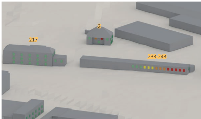
Abb. 36: Entwurfsituation Fensterlaibungsinnenwerte Werftstraße 217, 233-243 und Wilhelmstraße 2 Westfassaden (Eigene Darstellung. Modellgrundlage LoD2 und DGM5, LVermGeo SH, Stand: Juni 2020)
