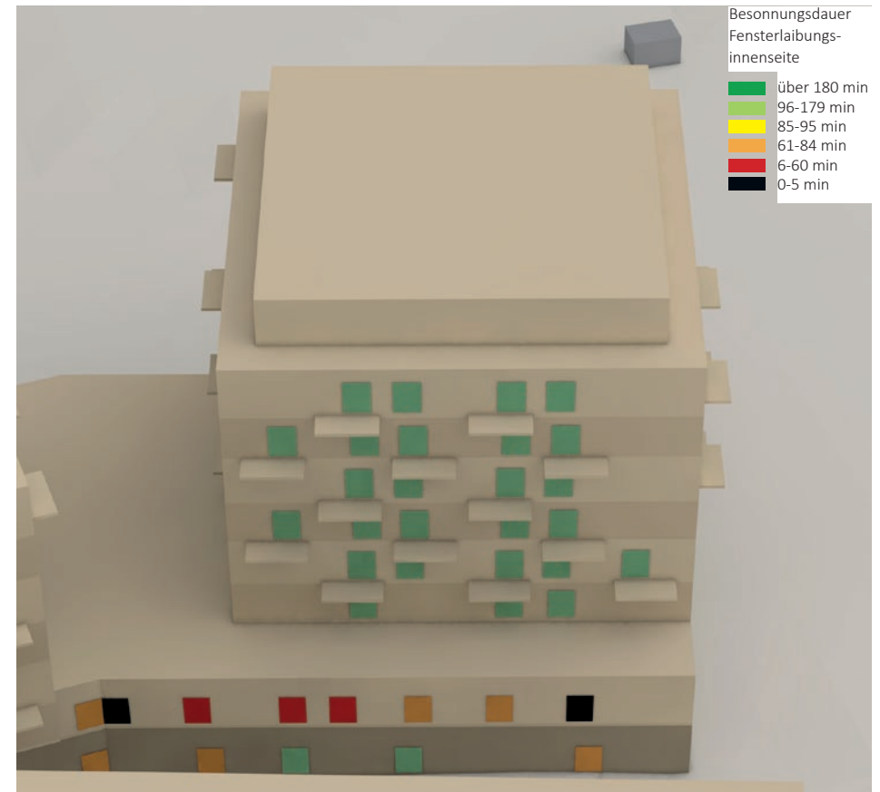
Abb. 57: BF C BT C Westfassade - Fensterlaibungsinnenwerte (Eigene Darstellung. Modellgrundlage: Vorhabenbezogene BP 1017V, 1030V und 1031V, Stand: 12.08.2022 und Auszug digitales LoD2-Stadtmodell und DGM5-Geländemodell der Landeshauptstadt Kiel, LVermGeo SH, Stand: Juni 2020)
