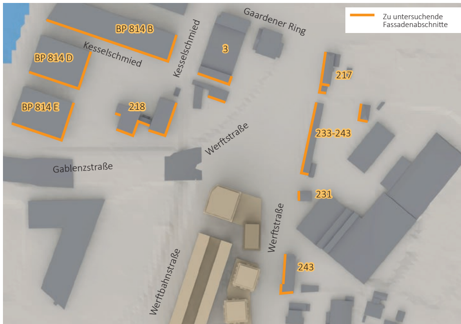
Abb. 28: Relevante Fassaden- Umgebungverschattung Quartier „Kool Kiel“ (Eigene Darstellung, Modellgrundlage: Landeshauptstadt Kiel, LVerGeo SH, Stand: Juni 2020)
