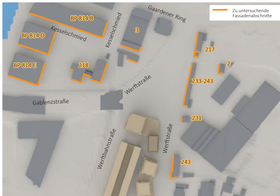
Abb. 30: Relevante Fassaden- Umgebungsverschattung Quartier „Kool Kiel“ (Eigene Darstellung. Modellgrundlage: Landeshauptstadt Kiel, LVermGeo SH, Stand: Juni 2020)
