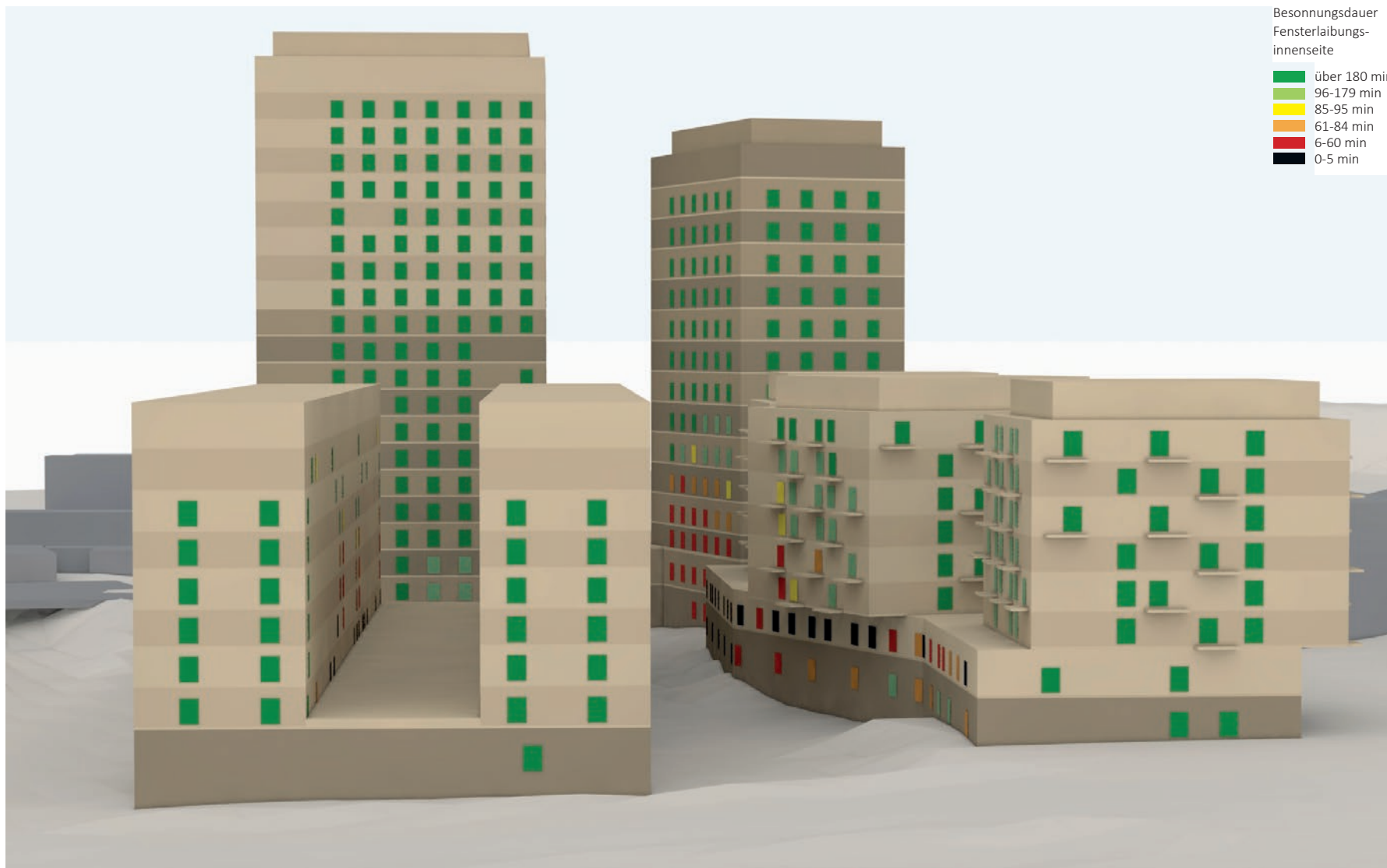
Abb. 52: BF B Südfassaden - Fensterlaibungsinnenwerte (Eigene Darstellung, Modellgrundlage: Vorhabenbezogene BP 1017V, 1030V und 1031V, Stand: 12.08.2022 und Auszug digitales Lod2-Stadtmodell und DGM5-Geländemodell der Landeshauptstadt Kiel, LVermGeo SH, Stand: Juni 2020)
